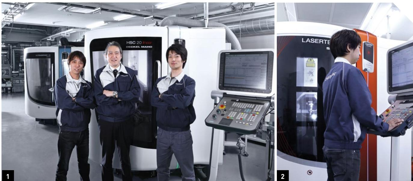
1. De gauche à droite : Yuki Kataoka – ingénieur, Kazuo Iwahori – directeur général, et Terukazu Mizuguchi – ingénieur, devant le centre d'usinage à grande vitesse HSC 20 *linear*. À l'arrière-plan, on reconnaît l'ULTRASONIC 20 *linear*. 2. La découpe laser sur 5 axes avec la LASERTEC 20 FineCutting est réalisée dans une salle climatisée afin d'assurer la précision requise.
