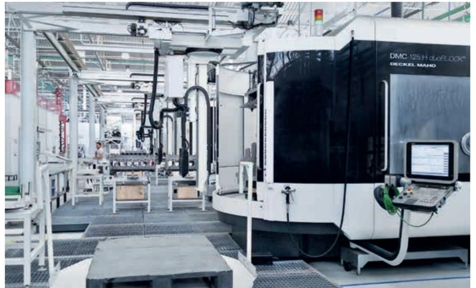
Chez FPT Industrial Argentina S.A., DMG MORI Systems a conçu un projet clé en main : une chaîne de production constituée de 13 centres d'usinage DMC.
