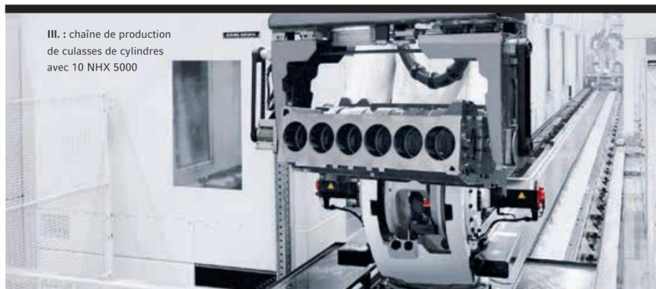
III. : chaîne de production de culasses de cylindres avec 10 NHX 5000
