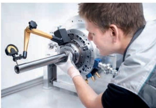
Contrôle géométrique de la machine et des broches pendant 18 heures.
