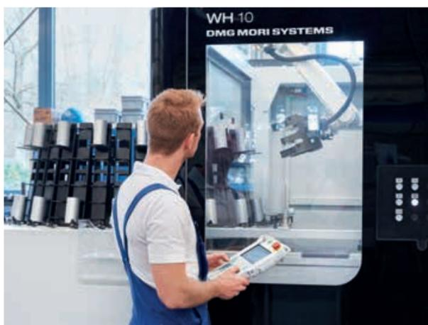
Le système de manutention du NLX 2500 est adapté aux pièces pesant jusqu'à 12 kg.
