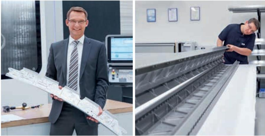
Jens Loll, gérant de Loll Feinmechanik, porte une pièce structurelle aéronautique, fabriquée sur une machine à montant mobile DMF de DMG MORI.
