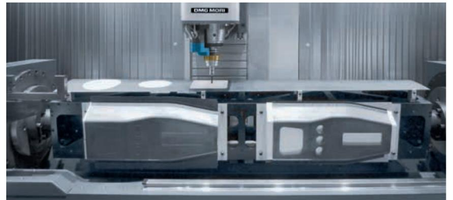
ULTRASONIC 260 avec cadre technologique intégré et dispositif de serrage des pièces spécial : rectification des segments de pales de rotor ; rognage, perçage et usinage de poches dans la console centrale en composites fibres de carbone.
