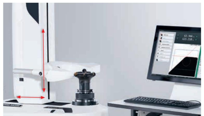
Pour le pré réglage et la mesure d'outils entièrement automatiques, sans intervention de l'opérateur (commandé par CN, 3 axes). Avec placard ergonomique et écran tactile 24" en standard.
