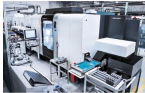
Fabrication sur le **SPRINT 65** avec une très grande précision, par ex. planéité de 0,004 mm.
