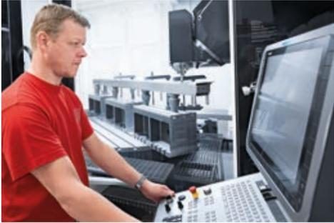
Usinage des grandes pièces en 5 axes simultanés sur la DMU 340 P.
