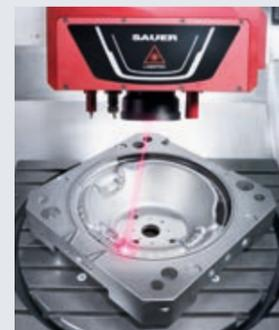
LASERTEC 65 Shape : texturation laser 5 axes / usinage d'un moule pour volant.
