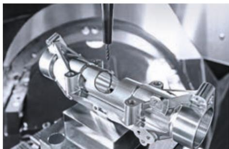
Usinage en 5 axes sur une DMU 60 eVo.
