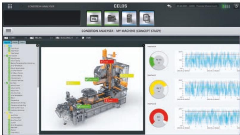
> Mesure, visualisation et analyse de la force, la vibration, la température et la lubrification.
