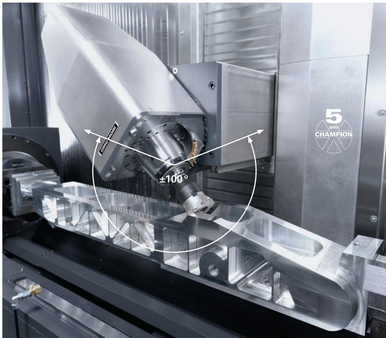
Usinage 5 axes d'une traverse sur la DMF 26017 avec cadre technologique.
