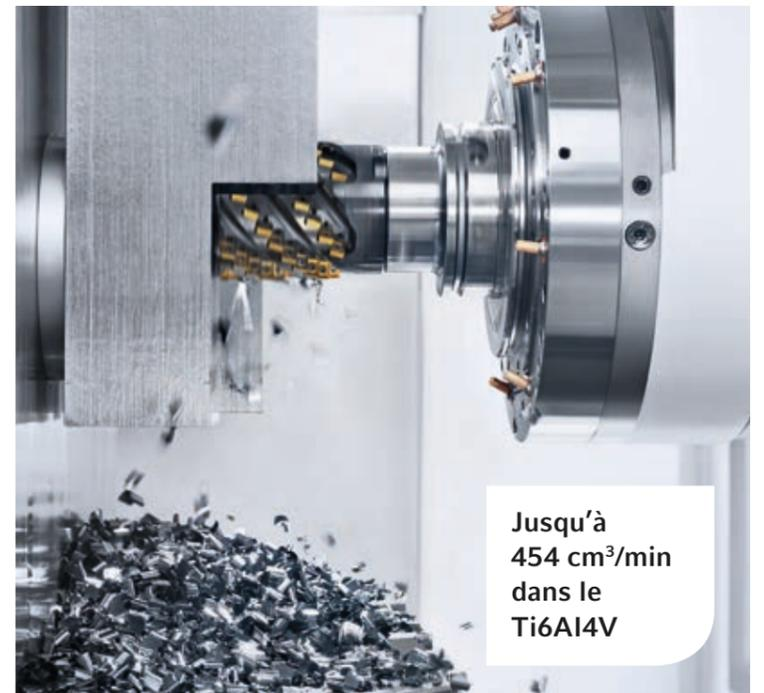
Jusqu'à 454 cm<sup>3</sup>/min dans le Ti6Al4V
