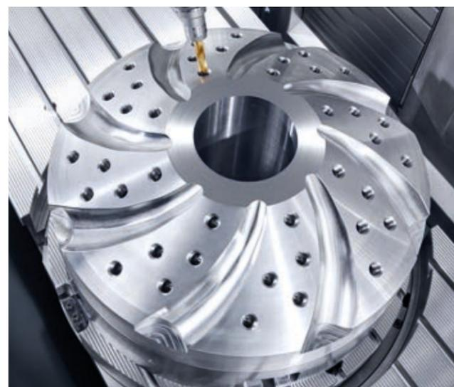
Table circulaire CN intégrée pour l'usinage en 5 axes et le fraisage-tournage.
