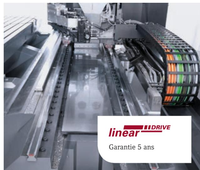
Entraînement linéaire dans l'axe X réalisant 80 m/min en rapide.
