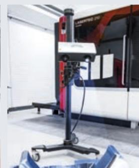
Mesure de la géométrie d'outil à l'aide d'un scanner 3D.
