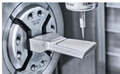
Usinage simultané en 5 axes des lames de fraises cylindriques sur le NTX 1000.
