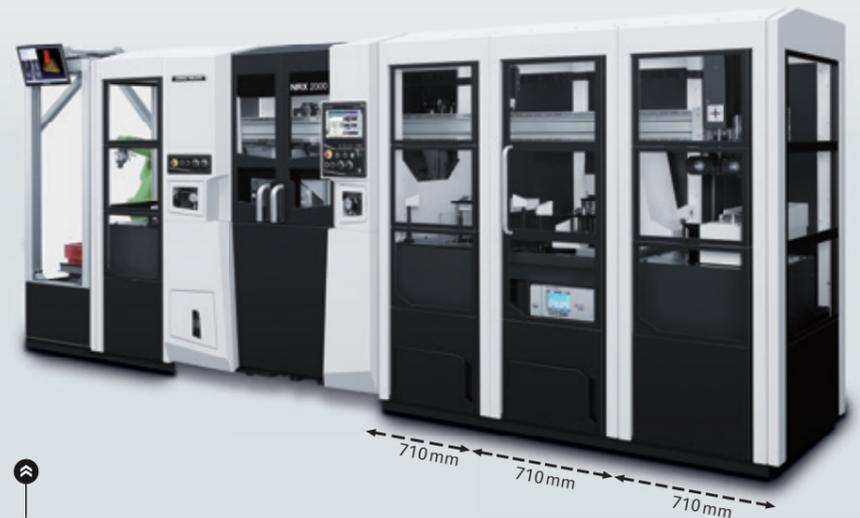
**NRX 2000 avec chargement par robot avec détection de position pour les pièces en vrac**
