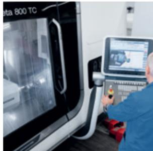
Des pièces complexes très précises sont désormais complètement tournées et fraisées sur une seule machine grâce au modèle CTX beta 800 TC.
