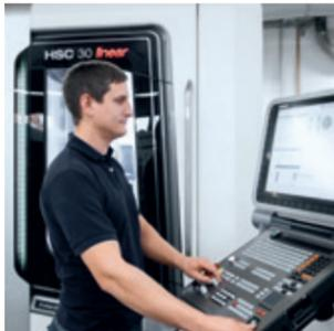
HSC 30 *linear* : une vitesse de 40.000 tr/min et les entraînements linéaires garantissent des usinages à la précision du micron, même avec des matières difficiles à usiner (ex. tungstène et cuivre).
