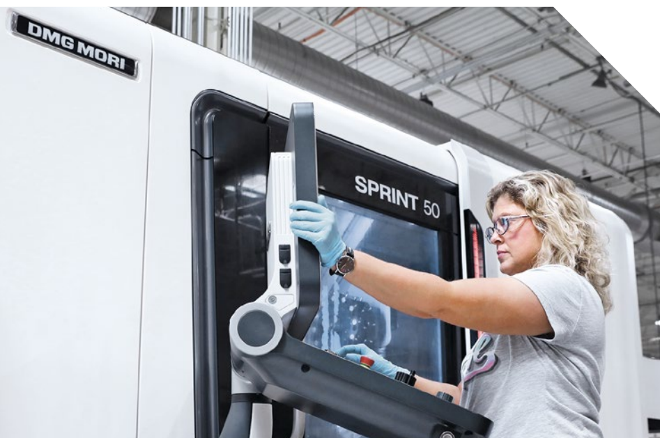
L'opératrice Erica Williams sur le SPRINT 50. Le tour de production permet le tournage automatique de la barre et de pièces en mandrin avec jusqu'à 36 stations d'outils.
