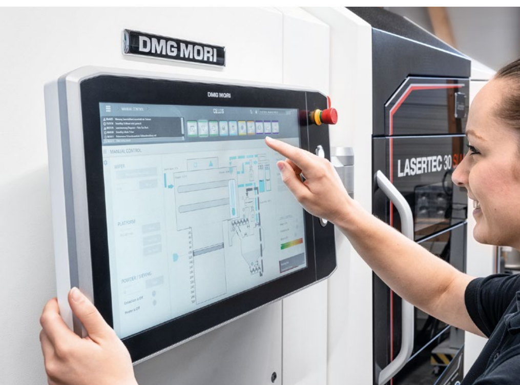
Le LASERTEC 30 SLM de 2 e génération est équipé de l'interface de commande et utilisateur standard CELOS.
