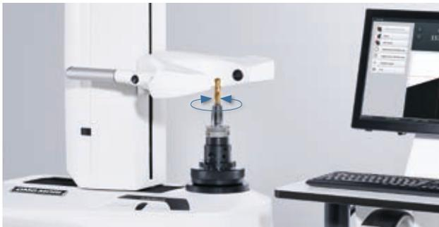
Pour la mise au point automatique sur l'arête de l'outil. Broche motorisée, placard ergonomique et écran tactile 22" en standard.
