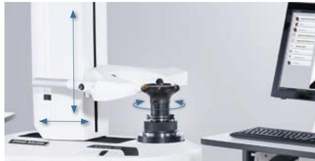
Pour le pré-réglage et la mesure d'outils entièrement automatiques, sans intervention de l'opérateur (commandé par CN, 3 axes). Avec placard ergonomique et écran tactile 22" en standard.
