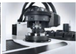
Processus optimal – frettage et pré-réglage d'outils en une seule opération (VIO *linear* toolshrink).
